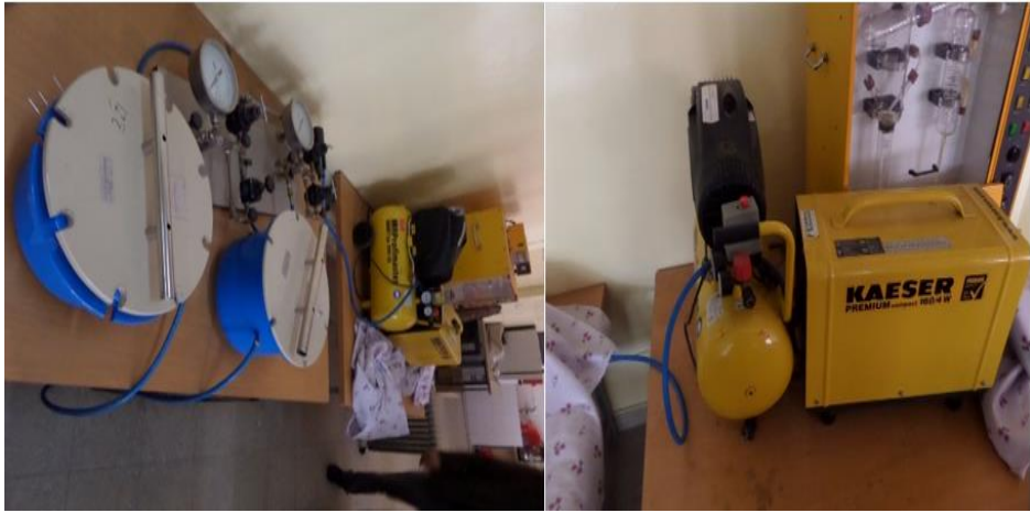
شکل ۱: دستگاه ریچارچ مورد استفاده برای تعیین اندازه‌ی مسامات و مقدار آب در بین مسامات موجود (۳)
